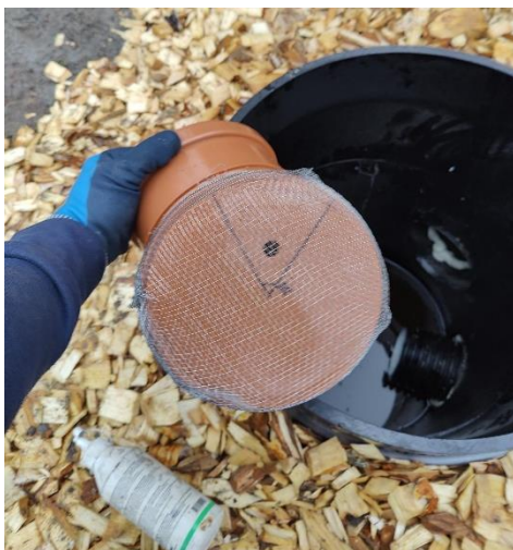
ä. Reikäkantta muuttamalla säädetään tulevaa virtaamaa
